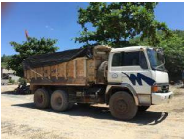
Xe chở đá luôn được che đậy kín thùng
