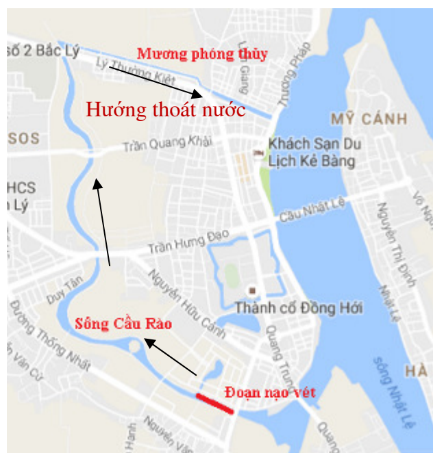
Hình 4.3: Hướng thoát nước khi nạo vét sông Cầu Rào
